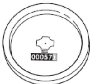
El medidor de tiempo muestra el número de horas que el motor ha estado operando.
